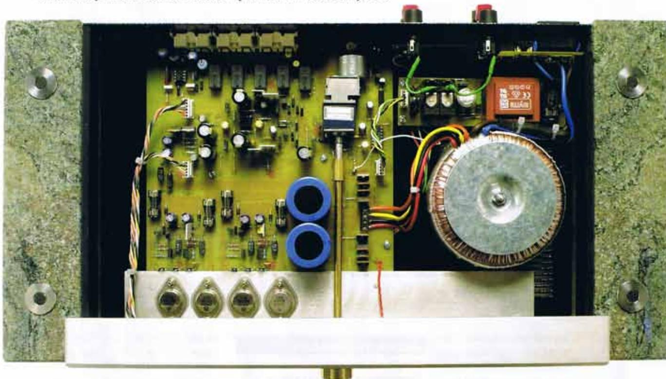
les enceintes acoustiques. Enfin, un bloc IEC comprenant le réceptacle de la prise secteur et l'interrupteur général achève ce tableau très complet. Le capot une fois ôté laisse voir des entrailles particulièrement saines et éprouvées. Toutes les entrées sont sélectionnées par relais (contact or sur béryllium) et les entrées lignes sont traitées en passif sans passer par aucun circuit électronique ni condensateur de liaison.
